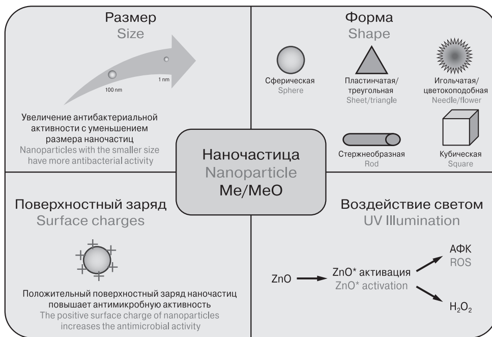
Рисунок 2. Факторы, влияющие на антибактериальные свойства наночастиц Figure 2. Main factors of antibacterial activity of nanoparticles
